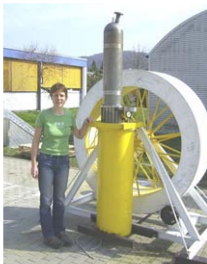
Średniotemperaturowy silnik Stirlinga z projektu Solar Power Village. Źródło: J. Kleinwächter, „Solar Power Village” 180 .
