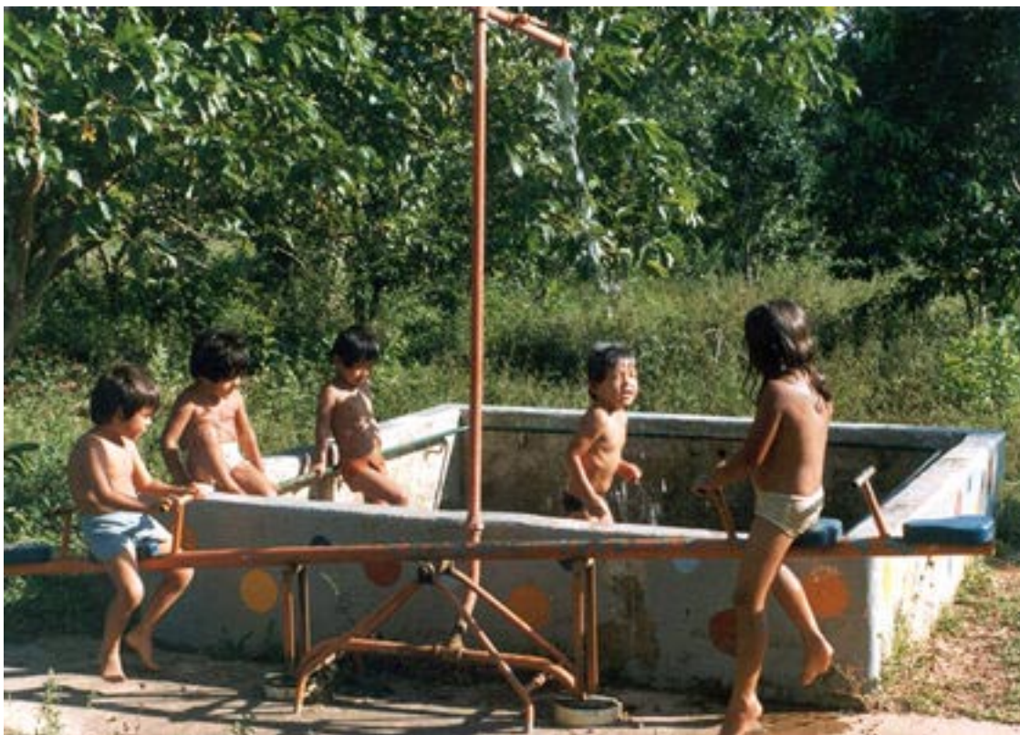
Działająca pompa głębinowa. Źródło: ZERI 56 .
