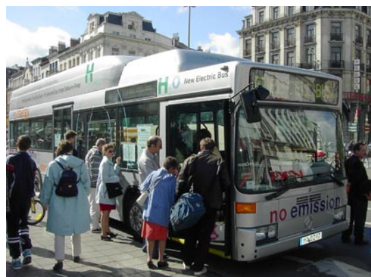
Prototyp autobusu z ogniwem paliwowym w Brukseli. Źródło: Europe Research News Centre 85 .
